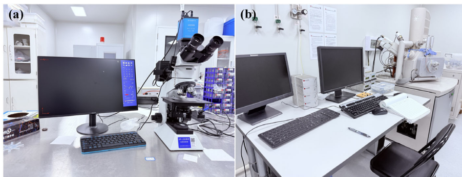
图 2.3 (a) 光学金相显微镜系统；(b) 场发射扫描电子显微镜 (SEM) 与能量色散光谱仪 (EDS) 系统
